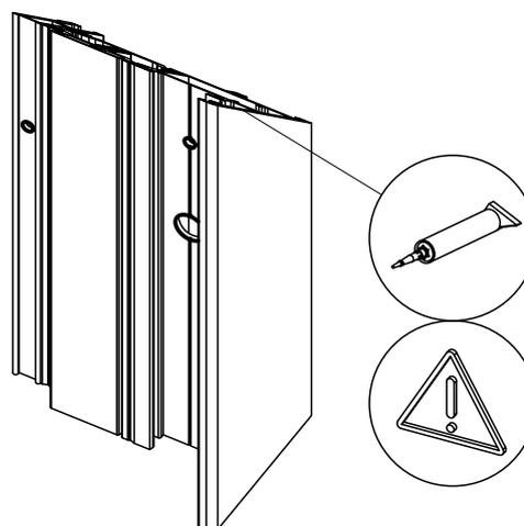
N.B. : ESEGUIRE IL FORO Ø 3mm PER LA COLLA CON IL TRAPANO
