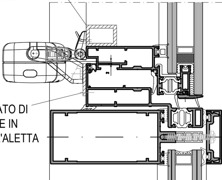
PREVEDERE UN PROFILATO RIPORTATO SULL'ANTA PER IL CORRETTO POSIZIONAMENTO DEL MOTORE.
